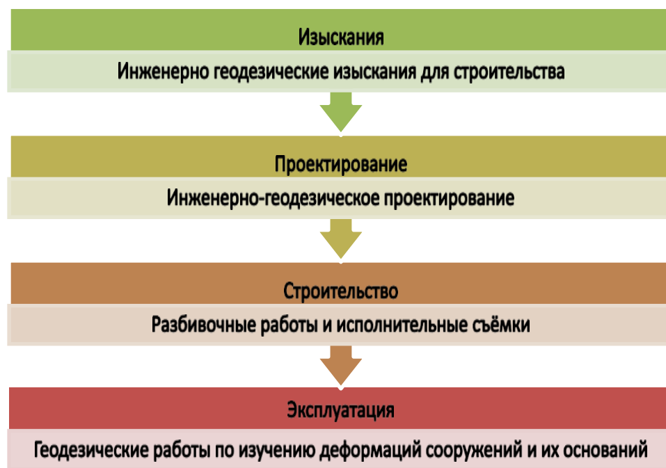
Рисунок 2 – Этапы инженерно-геодезических работ при строительстве инженерных сооружений
